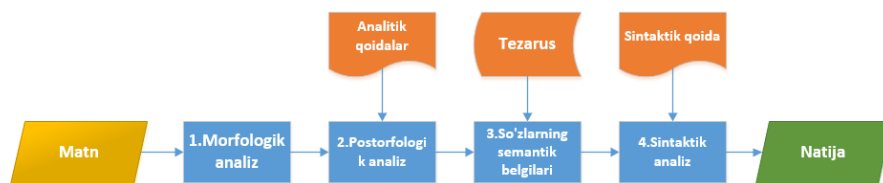
1-rasm. Matn analizatori bosqichlari
